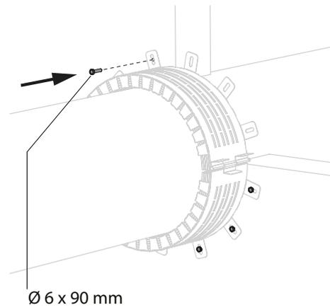
4. Utilisez des vis standard  $\text{Ø} 6 \times 90 \text{ mm}$  pour fixer le manchon à la paroi/dalle.
