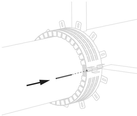
3. Fermez le manchon à l'aide du dispositif de fermeture. Glissez ensuite l'axe fourni à travers les charnières et repliez la languette protectrice.
