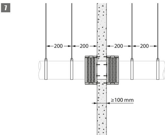
7. Le tuyau doit être supporté afin de pouvoir garantir le bon fonctionnement du colmatage lors d'un incendie. Les supports et fixations seront réalisés suivant les règles de l'art.
